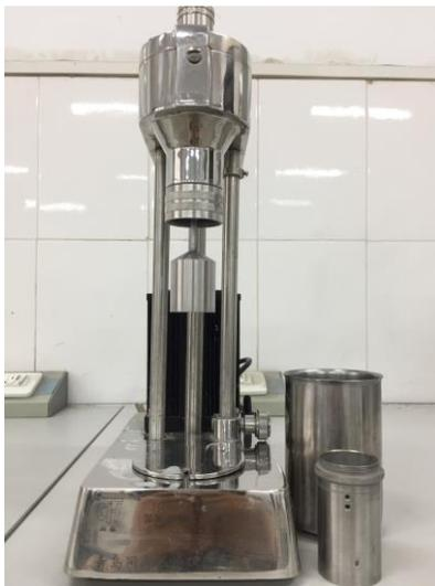
图4 ZNN-D6型旋转粘度计
