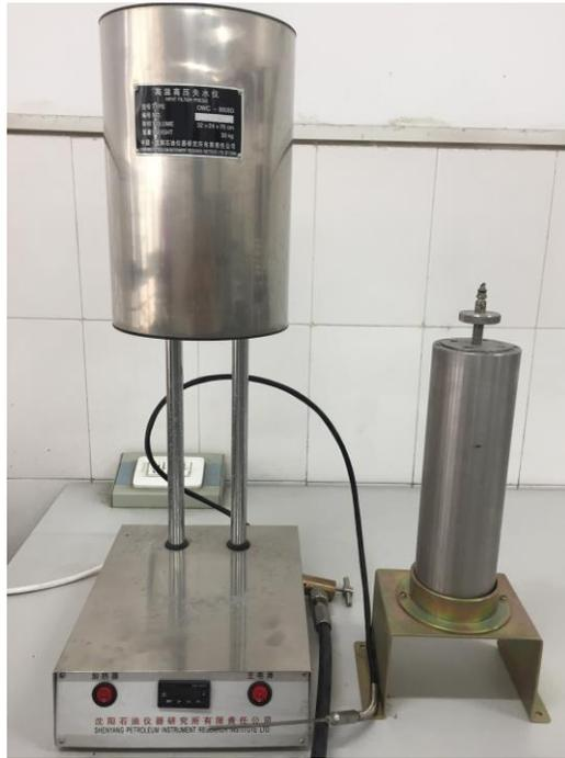
图6 OWC-9508D型泥浆失水仪
