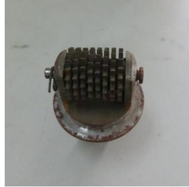
图1-2 微型牙轮钻头
