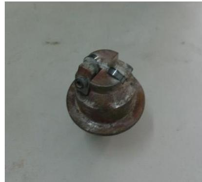
图2-2 微型PDC钻头
