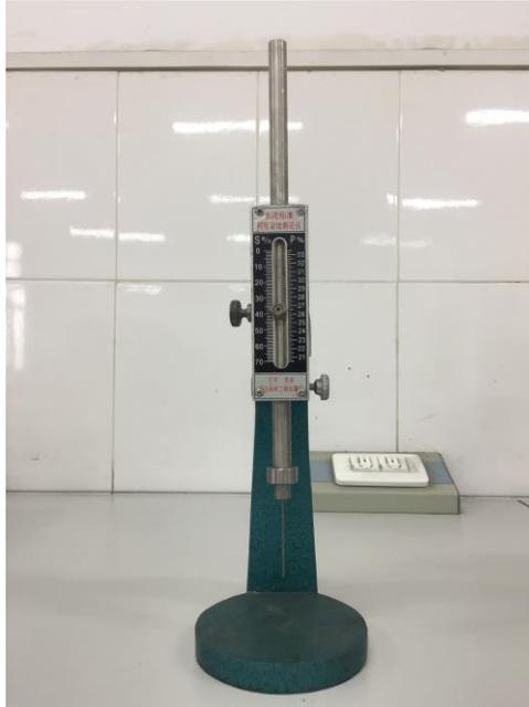
图5 凝结时间测定仪
