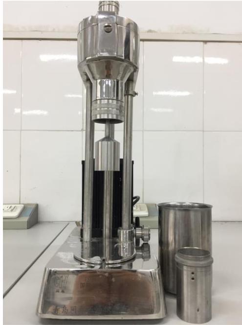
图3 ZNN-D6型旋转粘度计
